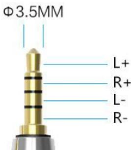
**注：**4 极平衡耳机可以直接插入非平衡 (PO) 口当成非平衡耳机使用，但是 3 极非平衡耳机一定不能插入平衡口 (BAL.) 使用，偶尔插入只要及时拔出不会对机器有任何的影响。
